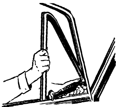
Рис. 73. Снятие поворотного стекла
